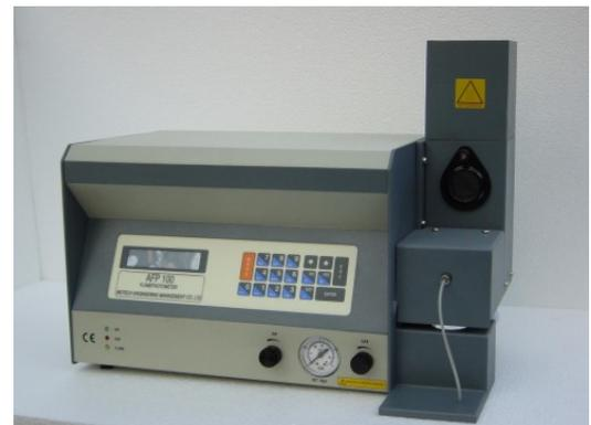
Im Gegensatz zur diskreten Atomisierung wird oft „Kontinuierliche Atomisierung“ gemacht (über längere Zeit eine konstante Menge Probe pro Zeiteinheit atomisiert und analysiert) häufig durch Zerstäuben einer Flüssigkeit in der Flamme
